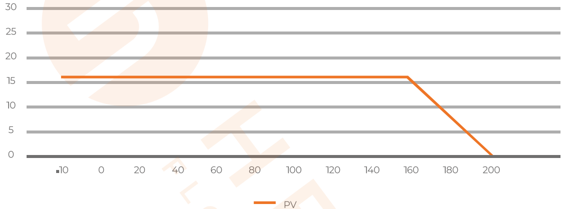
Диаграмма рабочей области крана «Температура / давление»
